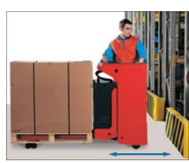
Nahezu gleicher Bremsweg, ob Fahrzeug unbeladen oder beladen.
